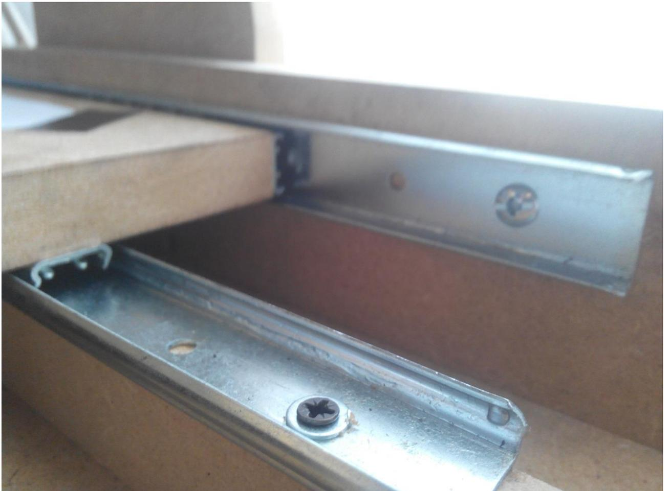
Per quanto riguarda l'asse Z, il progetto prevede l'impiego di guide lineari senza ricircolo di sfere, come quelle utilizzate per l'asse Y, ma questa volta, con una larghezza inferiore, arrivando ad utilizzare persino delle guide larghe la metà di quelle usate prima. Per adesso, l'asse Z non è stato ancora realizzato ma a breve lo sarà.
